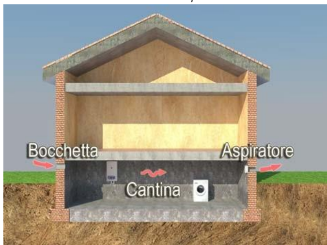
Schema dell'intervento di ventilazione forzata delle cantine.
