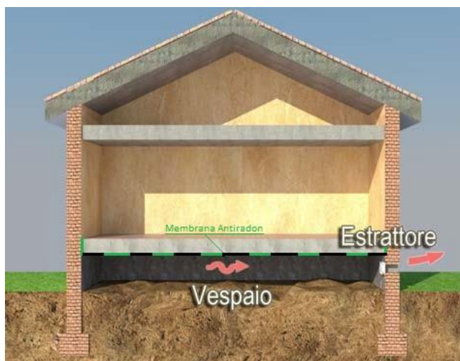
Schema di ventilazione naturale del vespaio.
